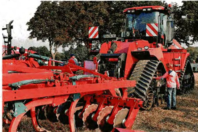
Trotz hohen Gewichts bodenschonend dank Gliederketten: Der 580 PS Ackerbolide mit angehängtem Grubber. nah
